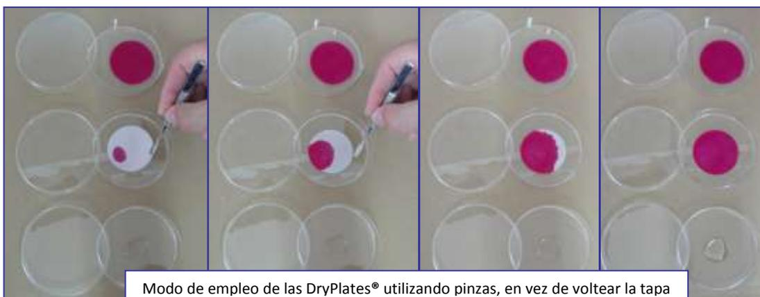
Modo de empleo de las DryPlates® utilizando pinzas, en vez de voltear la tapa
